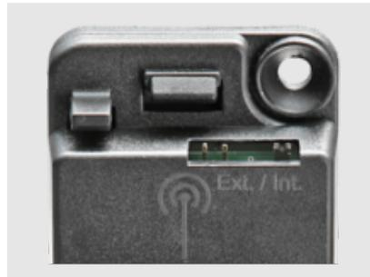
Conexión para una antena externa.
