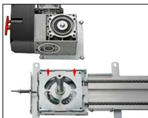
L'automatisme se fixe sur le support moteur en acier et est relié à l'arbre d'entraînement.
