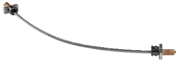
Die Absturzsicherung Safeguard DTA verhindert im Falle eines Scharnierbruchs das Umfallen von Torflügeln bei Drehtoren. Mit ihm wird der Norm EN 12604 Rechnung getragen. Sie schreibt vor, dass beim Versagen eines einzelnen Elements des Befestigungssystems der Torflügel nicht umfallen darf.
