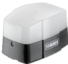
Das Warnlicht hat eine geringe Bauhöhe von 75 mm. Als Leuchtmittel dient eine mit gelben LEDs bestückte Platine. Die Einschaltdauer beträgt 50 %. Das Warnlicht ist nicht selbstblinkend.
