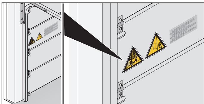
插图 1.2：将标签安装在门板上
