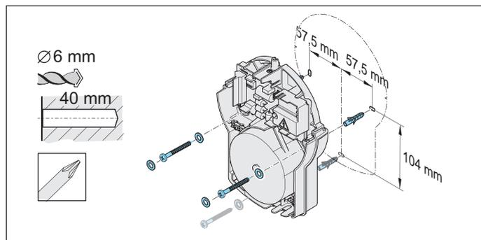
插图 4：安装示例
