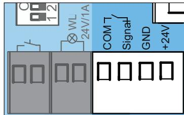
插图：4 线光栅的连接端子
