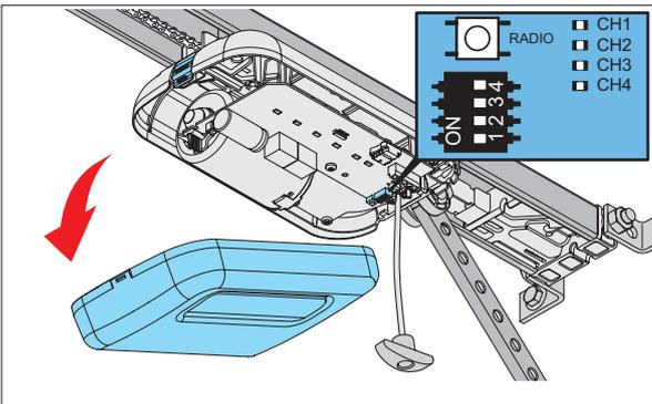
2. 取下门滑动机构护罩。
