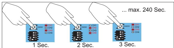
4. 计算 LED 交替亮起时的开门时间。达到所需时间长度后，松开 RADIO 按钮。
