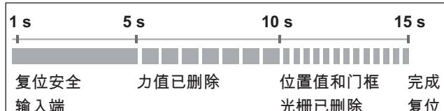
插图：在按下绿色 Reset 按钮时门滑动机构上 Status-LED 的时间顺序概览
