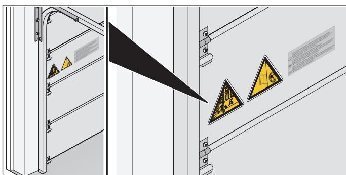
插图 1.2：将标签安装在门板上
