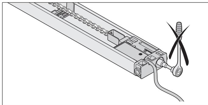
插图：带控制电缆的内插件
