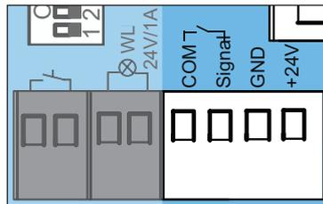
插图：4 线光栅的连接端子
