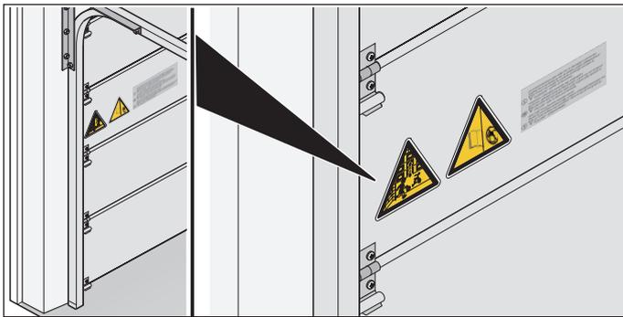
插图 1.2：将标签安装在门板上
