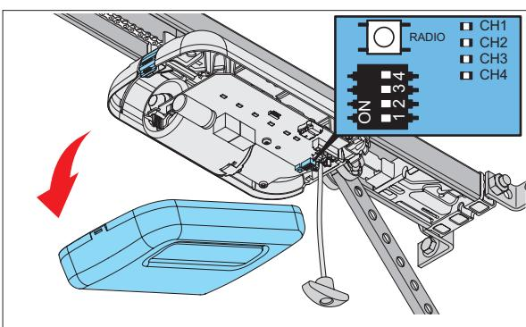
2. 取下门滑动机构护罩。
