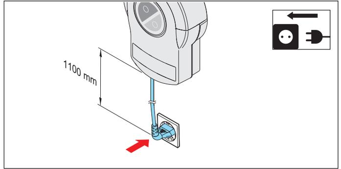
插图：墙壁控制器与插座的间距
