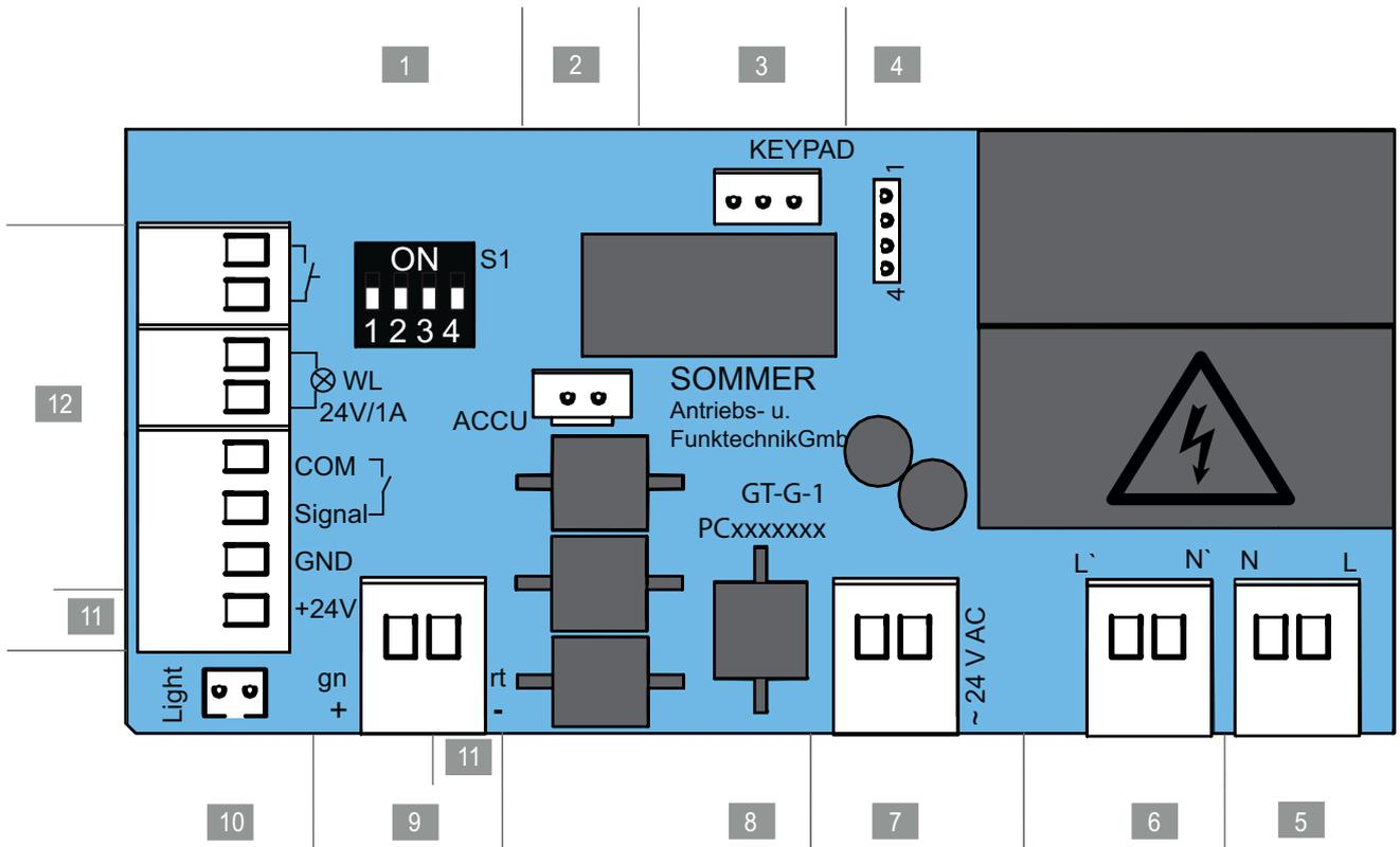
插图：墙壁控制器的电路板，完整规格\*
