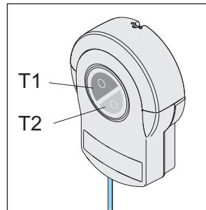
插图：墙壁控制器的膜式按钮 T1 和 T2
