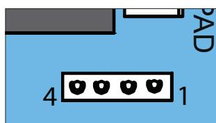
插图 : Output OC 的继电器插槽
