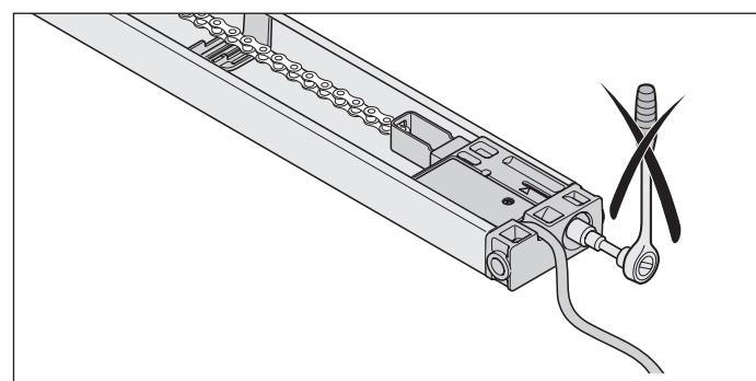
插图：带控制电缆的内插件
