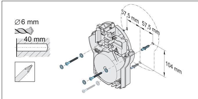
插图 4：安装示例
