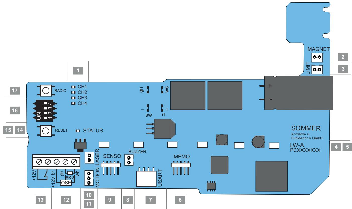
插图：门滑动机构的电路板（完整规格\*）
